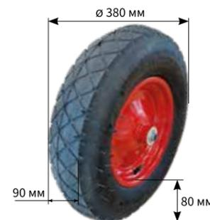
Пневмо колесо 4.80/4.00-8 для одноколесной тачки садовой/строительной. Посадочный диаметр 14 мм. Обладает повышенной проходимостью. Максимальная нагрузка не более 180 кг на колесо.
