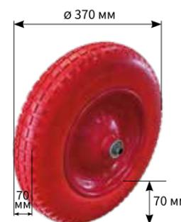
Литое колесо 3.25/3.00-8 для тачки садовой/строительной изготовлено из полимера, бескамерное, не подвержено порезам и проколам. Предназначено для одноколесных тачек с посадочным диаметром 12 мм. Максимальная нагрузка не более 180 кг на колесо.
