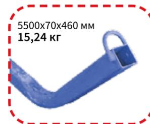
Кронштейн ЗУС - главная направляющая и основная несущая часть конструкции защитно-улавливающей сетки. Устанавливается в нижнюю опору и фиксируется при помощи болта и гайки М16. При помощи плетеного шнура и карабинов между двумя кронштейнами натягивается защитно-улавливающая сеть. Конструкция подвешивается к верхней опоре посредством каната с толщиной плетения 10 мм. Кронштейн изготавливается из стали с применением широкого многослойного сварного шва для закрепления такелажной серьги.
