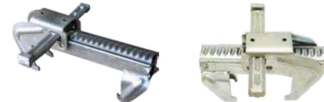
Уникальная конструкция замка, позволяет стягивать, выравнивать щиты и зажимать доборные вставки до 100 мм. Замок имеет отличное сопротивление возможной вибрации. Используется для соединения линейных и радиусных щитов, колонн, а также для формирования внешних углов из линейных щитов опалубки.
