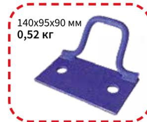
Верхняя опора для кронштейна ЗУС предназначена для закрепления кронштейна с предварительно натянутой защитно-улавливающей сетью на каркасе здания. Пластина и крюк изготавливаются из стали с применением широкого многослойного сварного шва.
