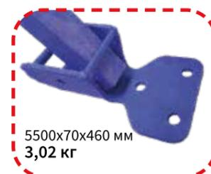
Нижняя опора для кронштейна ЗУС предназначена для закрепления кронштейна с предварительно натянутой защитно-улавливающей сетью на каркасе здания. Изделие изготавливается из стали с применением широкого многослойного сварного шва. В опору вставляется кронштейн и зажимается при помощи болта М16 и гайки аналогичного диаметра.
